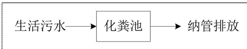
图 2 废水处理工艺流程图
